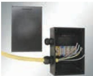
In fase di installazione, terminati i collegamenti dei cavi di ingresso e di uscita è vivamente consigliato l'utilizzo di gel sigillante dielettrico IP68, colato dentro la cassetta a totale copertura dei morsetti e dei cavi. (Utilizzare Ray Tech „Magic Gel" o similari).
