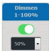
Nella modalità „Dimmer” può essere impostato in passi da 1% il grado di luminosità. La selezione avviene tramite la tastiera oppure scorrendo nella finestra. Qui vengono ignorati inserimenti errati. Quando si attiva il “Dimmer” vengono disattivati automaticamente le funzioni FLASH e BLINK. I tasti vengono disattivati e cambiano da verde a rosso. L'emissione sul canale avviene col pulsante “esegui”.
