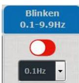
Nella modalità “FLASH” può essere selezionata la frequenza da 0.1-9.9Hz in passi da 0.1Hz. Durante questa modalità non può essere selezionato il grado di luminosità. L'impostazione di questo valore avviene tramite la tastiera oppure scorrendo nella selezione. Quando viene attivata questa funzione le altre funzioni “Dimmer” e “BLINK”. I tasti vengono disattivati e passano dal colore verde a rosso. Inserimenti errati vengono ignorati. L'emissione sul canale avviene tramite il pulsante “esegui”.
