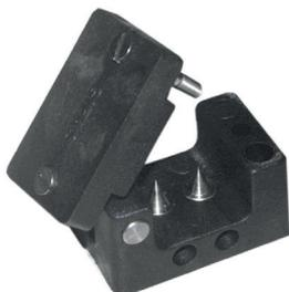
Morsetto di derivazione a perforazione di isolante realizzato in poliammide autoestinguente V0 con elevata resistenza meccanica. Punte di contattazione e perno in acciaio inox AISI316, viteria in acciaio inox AISI 304.
