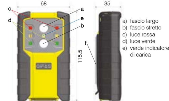
Funzioni lampada con batterie 1'900mAh o batterie ricaricabili
