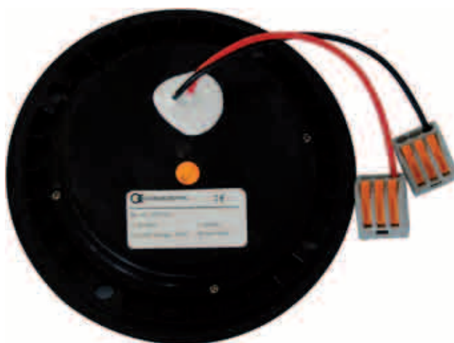
CircLED® Unità elettronica a LED inglobata in resina
