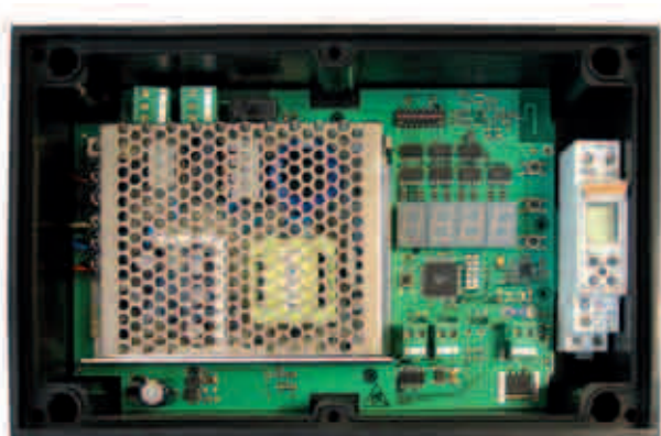
Centralina di controllo a 1 canale
